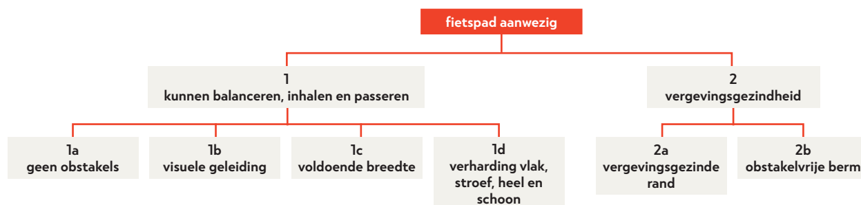
Afbeelding 2.1 Ontwerpprincipes voor een voldoende veilig fietspad.
